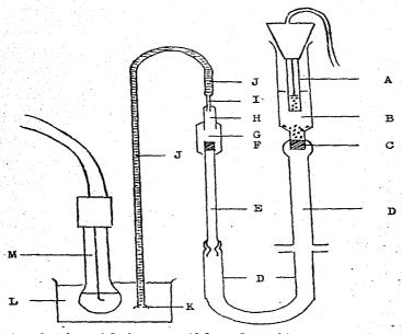
M : Electrodo de vidrio sensible al sodio A : Electrodo de referencia de calomel
