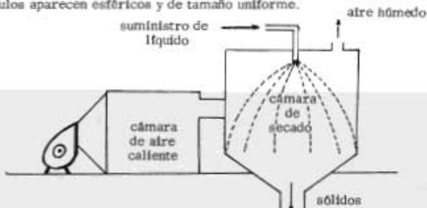
El proceso de secado por aspersión, muestra el principio general de secado resultante bajo aumentos
