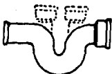
SIFONES CORRIDOS CON UNA O DOS VENTILAS DE CAMPA- NA O SIN ELLAS.
