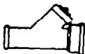
RAMAL PARA VACIAR EN FORMA DE Y CON TAPON DE BRONCE EN EL RAMAL
