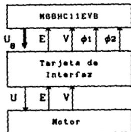
Fig. 4.1 Transmisión de señales entre M88HC11EVB y motor.
