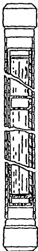
FIGURA 14 : ESQUEMA DEL CORTE TRANSVERSAL DE LA FUENTE DE COBALTO - 60 FABRICADA POR ATOMIC ENERGY OF CANADA LTD,
