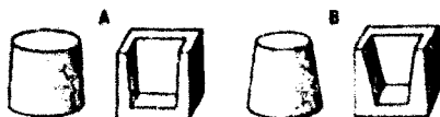
Fig. 3 Las superficies en oposición tanto si son externas como si son internas deben tener una conicidad de 6° (A). Una excesiva conicidad de 20° por ejemplo (B) ofrecerá una retención muy baja.
