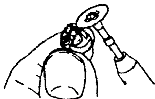
Fig. 32 Termine suavizando los márgenes con disco de papel de lija.
