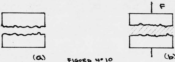
La figura (a) si se llena completamente con un líquido humectante los huecos que quedan entre dos planos pulidos, el líquido mantendrá unidas las placas frente a la fuerza de tracción (F) la intensidad de esta fuerza viscosa es algo que se puede predecir
