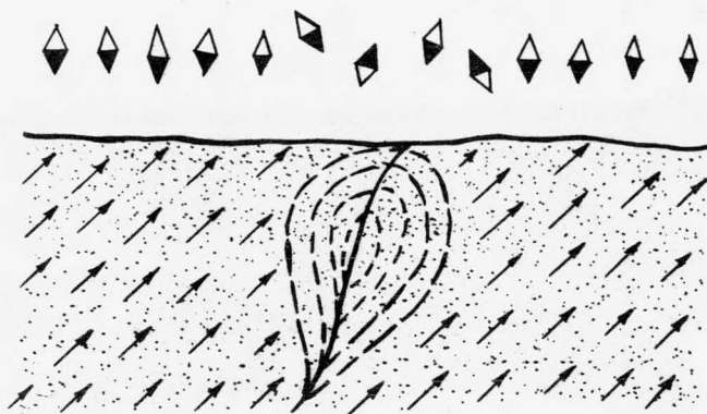
Fig.9. La magnetometría mide las alteraciones - del campo magnético de la tierra, relacionan - dolas con la estructura del subsuelo.
