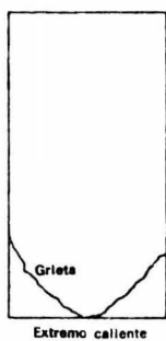
FIG. 197 Típica fractura de desconchado que ocurre a menudo en servicio. ( J. Am. Ceram. Soc. )
