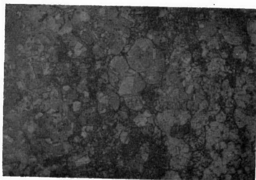
Cobre Puro Mal Sinterizado - 200X
