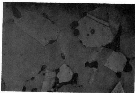
Cobre Puro Bien Sinterizado - 200X
