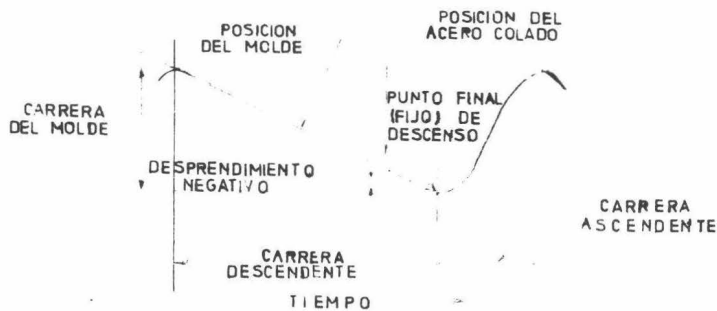
Fig. 1 .- En el desprendimiento negativo, el molde desciende algo más que el acero.
