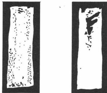
GRAFICA No. 5 CORTE LONGITUDINAL DE UN LINGOTE DE ACERO EFERVECENTE (IZQ.) Y ACERO MUERTO (DER).
