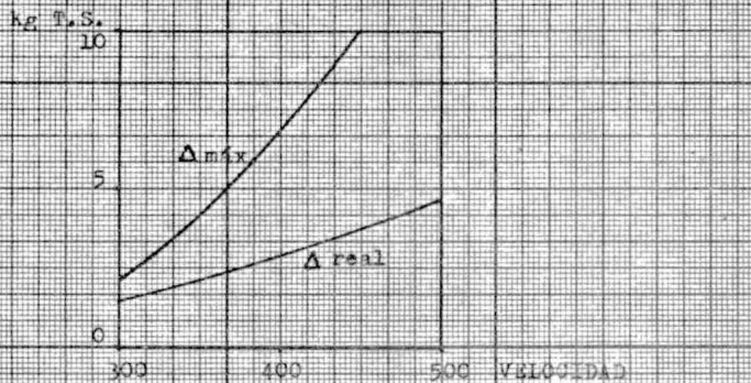
FIGURA 2.4 VARIACION DE \Delta_{max} Y \Delta_{real} CON LA VELOCIDAD PERIFERICA.
