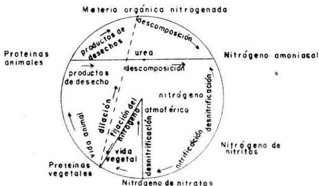
Los desechos humanos y animales transportados por las aguas residuales contienen nitrógeno en forma orgánica. En condiciones aerobias, las bacterias autótrofas nitrificantes (el grupo de las nitrosomas) convierte al amoníaco a nitritos aprovechando la energía generada en tal oxidación.
