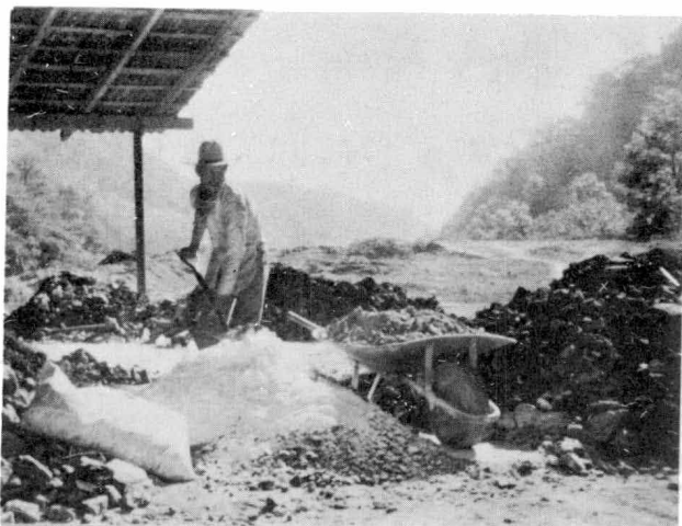
Fig. 21 MEZCLA DE MINERAL DE MERCURIO (CINABRIO) CON OXIDO DE CALCIO (CaO).
