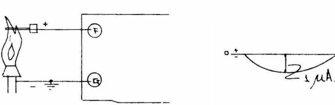
Debido a que el area de la varilla es muy pequeña, se tendrá una corriente de 1 microampere; sin embargo cuando la polaridad cambia se tiene que:
