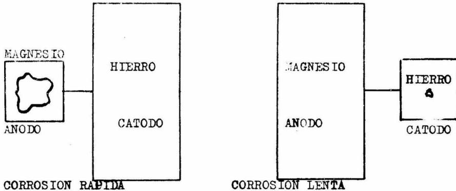
Cuando usamos remaches de un metal determinado para unir láminas de otro metal diferente, tendremos un magnífico ejemplo de los posibles efectos de la corrosión galvánica.
