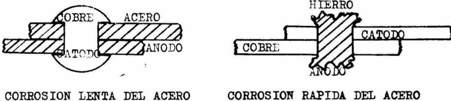
Los mismos resultados pueden lograrse suministrando corriente eléctrica de una fuente externa debidamente al metal que se desee proteger. En éste sistema pueden usarse fuentes de corriente directa, generadores, rectificadores, con acumuladores y pilas secas, con el objeto de evitar la rápida desintegración del ánodo se escoge generalmente un metal inerte.
