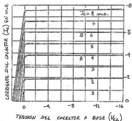
Fig. 2.14 Características de salida de base a masa : 2N34.
