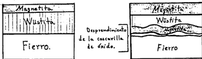
El eutectoide fino, se forma, debido a la transformación eutectoide de la wüstita, que ocurre a 560 °C (ver capítulo 1). Debido a que el enfriamiento de la cascarilla es relativamente rápido, se forma un eutectoide laminar, muy fino. El eutectoide, fué difícil de detectar, por que se forma en pequeñas cantidades, más sin embargo se detectó, a 15X100 aumentos bajo el microscopio óptico. Esta es una clara evidencia, de que hubo wüstita y que se descompuso en fierro y magnetita.
