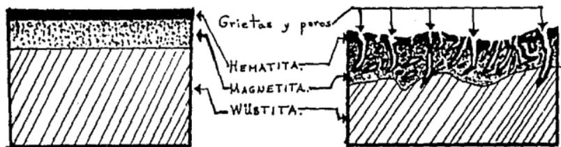
La cascarilla residual de óxido atigrado, observada en láminas decapadas, no se eliminó completamente durante el decapado, probablemente por que la cascarilla inicial formada durante la laminación en caliente, desarrolló una capa externa de hematita (que es el óxido más resistente al decapado) muy abundante.
