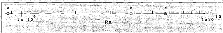
Figura 2.6 Ubicación de los casos estudiados en una escala logarítmica del número de Rayleigh. a. q'' = 100 \text{ W/m}^2 ; b. q'' = 460 \text{ W/m}^2 ; c. q'' = 700 \text{ W/m}^2 .
