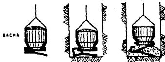
Figura 6.22 Funcionamiento de una bacha.
