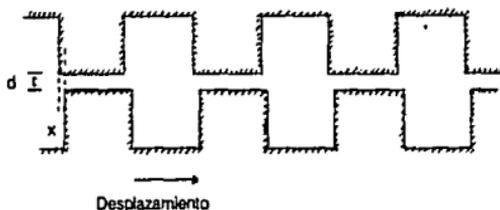
Fig. 1.13 Capacitor de placas dentadas
