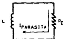
Fig.2-22 Modelo eléctrico de la corriente parásita.
