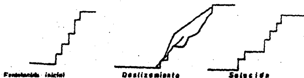
Fig. No. 10 Deslizamiento producido por una cuña formada por la intersección de dos fallas en la MINA "FERROTEPEC"
