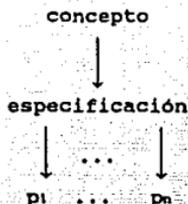
Figura 2.2. Un concepto, su especificación, y todos los programas para los que se puede probar que son equivalentes a la especificación.
