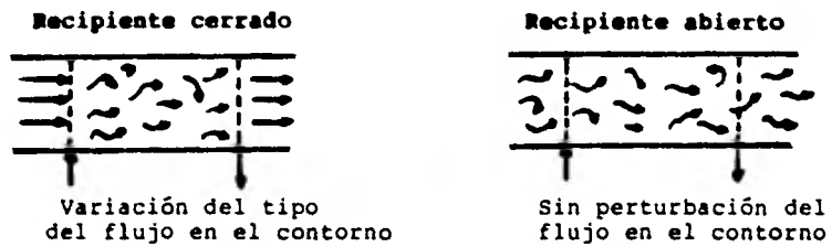
Fig. 1.1-8. Condiciones posibles de contorno para un recipiente con flujo.
