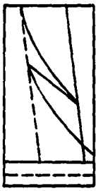
FIG. 8.c. A LA PROFUNDIDAD DE LA ZONA DE LA TERMINACION DONDE LA CAIDA DE PRESION ES PEQUENA DEBIDO A LA ALTA PRESION DE FLUJO DE LA COLUMNA DE FLUIDO.
