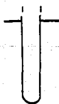
Fig. 4 CHAPA DE COBRE EN FORMA DE U PARA LA IMPERMEABILIZACION DE JUNTAS.
