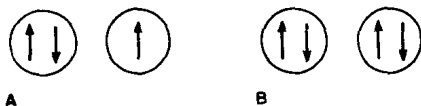
Figura 8. (A) estructura electrónica del radical anión superóxido ( O_2^- ). Nótese que el oxígeno ha sufrido una reducción univalente por captación de un electrón, pero sigue siendo un radical pues tiene un electrón no apareado. (B) peróxido. En la reducción univalente se obtiene peróxido de hidrógeno (reacción 5 página 36) (Huberman, 1988).
