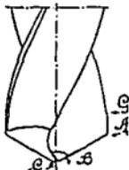
Además, si a toda la hélice de la broca sobre la cual está situado el punta (A), le siguiera una superficie que tuviera ángulo de incidencia, el ángulo vivo que se formaría sería muy frágil y haría que el filo se desgastase muy rápidamente; por esta razón las brocas tienen unas superficies de guía cilíndricas como se ilustra a continuación, de una anchura reducida y que refuerzan el contrafilo de la broca.
