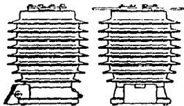
Clase: 34.5 kV., Aplicación: Medición- Aplicación: Medición-Protección. Tipo: Bobinado.
