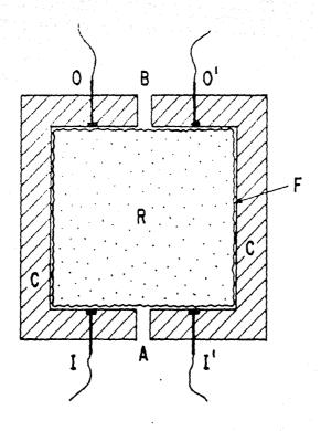
FIG. 3.6 - SISTEMA PARA ESTUDIAR LOS MEDIOS POROSOS FRACTURADOS.
