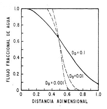
FIG. 4.4.— FLUJO FRACCIONAL DE AGUA PARA UN VOLUMEN ACTIVO INYECTADO  $t_D$  = 0.5.
