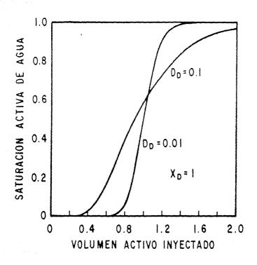
FIG. 4.3 — COMPORTAMIENTO DE LA SATURACION ACTIVA DE AGUA A LA SALIDA DE DOS MUESTRAS.
