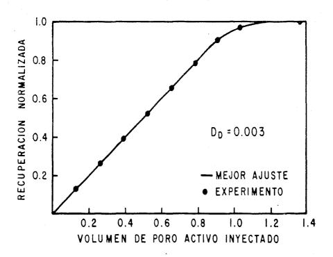
FIG. 4.6. COMPARACION ENTRE LAS PREDICCIONES DEL MODELO Y PUNTOS EXPERIMENTALES.
