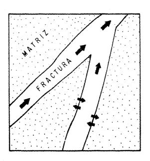
FIG. 3.2 - MECANISMO DE DESPLAZA-MIENTO DE FLUIDOS EN UN MEDIO POROSO FRACTURADO.
