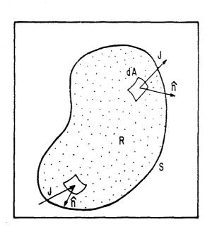
FIG. 3.3 - REGION R DEL MEDIO POROSO LIMITADA POR LA SUPERFICIE S.
