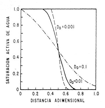
FIG. 4.2 - PERFIL DE SATURACION PARA TRES SISTEMAS CUANDO SE HA INYECTADO UN VOL. ACTIVO  $t_D = 0.5$ .
