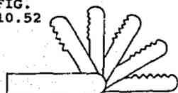
Estos calibradores son un juego de plantillas, cuyos perfiles coinciden con el perfil de cualquier rosca, con lo cual se identifica su tipo y medida. Los hay en sistema inglés y en sistema métrico decimal.
