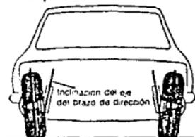
Un exceso de cámbér positivo hace que los bordes externos de la llanta se gasten más rápidamente que los internos. Las ruedas delanteras suelen tener un ligero cámbér positivo para proporcionar estabilidad en las curvas y en carreteras con coronas anchas.
