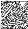
Fig.-5.4. Microestructura de un acero de alto carbono templado, placas de martensita
