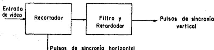
Figura 4.3.6.6 Diagrama de bloques del circuito de sincronía.
