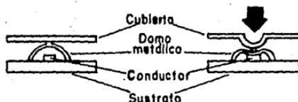
Figura 2.6.5 Interruptor de domo metálico.
