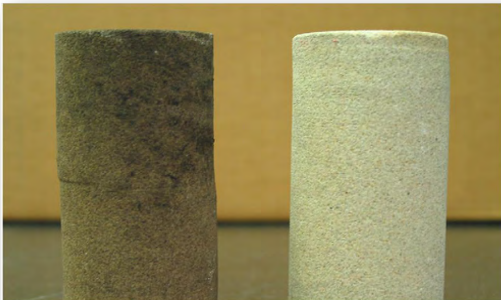
Fig. 2.3. Representación de un núcleo antes y después de ser tratado con microorganismos. Tomado de Brown (2010)
