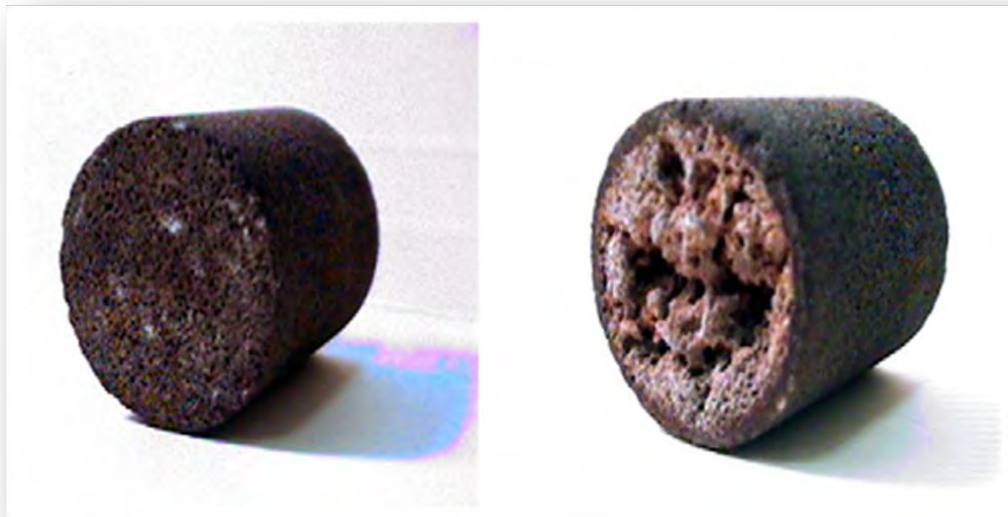
Fig. 2.2. Ejemplo de disolución de carbonatos por el uso de microorganismos. Tomado de Brown (2010)
