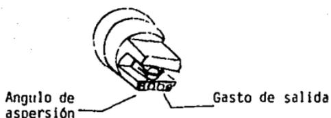
Fig. 8 CLAVE DE IDENTIFICACION DE UNA BOQUILLA DE ABANICO.
