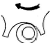
c) DESGASTE INTERNO NORMAL DEL BUJE
