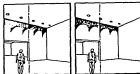
Fig. 3.27d. Figuras de intersección desagradables sobre una pared; se evitan colocando el mismo número de luminarias a ambos lados de la línea central.
