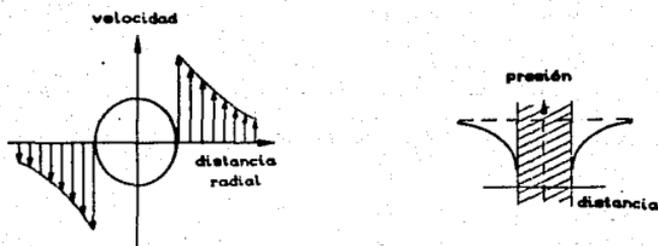
Fig. 2.2 (a) Distribución de la velocidad en un vórtice potencial. (b) Distribución de la presión en este mismo vórtice [1].
