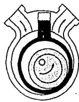
Fig. 5.40 BOMBA DE RECUBRIMIENTO FLEXIBLE
