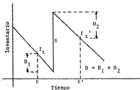
FIG. 3 - 5. Estructura de un sistema típico de inventario:  $I_{t'} = I_t + S - D$ .
