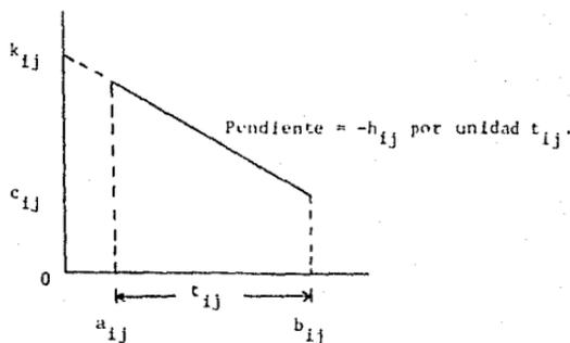
FIG. 3 - 27. Gráfica de la ecuación:  $c_{ij} = k_{ij} - t_{ij}h_{ij}$ ,
