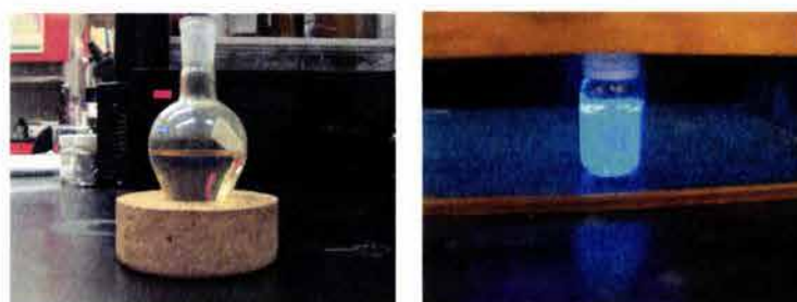
Figura 44. Fotografías de una disolución del compuesto c2 en hexano-acetato de etilo (9:1) en ausencia y presencia de luz UV a 366nm
