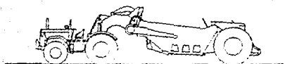
Desmonchadora o scraper de gran potencia. Vista de perfil de la máquina con el scraper.
