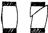
FIGURA IV. 3. Formas t picas de probetas rotas en una prueba triaxial con bases r gidas.
