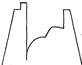
FIG. 60.- INTERFERENCIA EN EL POZO. EL DST. ES GENERALMENTE POCO SENSIBLE PARA NOTAR LA INTERFERENCIA EN LOS POZOS. SE PUEDEN RECUPERAR FLUÍDOS DEL YACIMIENTO EN CANTIDADES SUPERIORES A LAS NORMALES. 16
