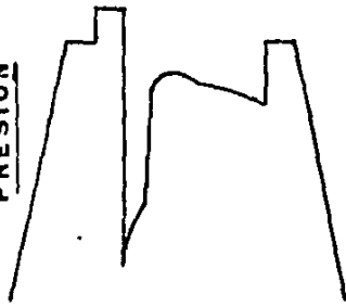
FIG. 39.- EL EFECTO DE UNA GRAN PRESIÓN. EL INCREMENTO DE PRESIÓN DURANTE EL FLUJO Y EL PERÍODO DE INCREMENTO SON MAS RÁPIDOS QUE LOS DE COSTUMBRE. EL LODO RECUPERADO ES TAMBIÉN ABUNDANTE. LA ALTA PRESIÓN PUEDE O NO EXCEDER A LA PRESIÓN NORMAL DE YACIMIENTO. 16
