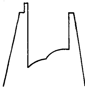
FIG. 36.- UN ERROR UNIFORME EN EL MECANISMO DEL RELOJ. LA ESCALA DEL TIEMPO ESTÁ EQUIVOCADA. SE RECUPERA FLUIDO DEL YACIMIENTO EN CANTIDADES NORMALES. 16
