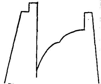
Fig. 50.- Un yacimiento con transmisibilidad moderada. Los flujos de la formación fluyen a la superficie. La forma de las curvas depende de la permeabilidad, viscosidad, volumen y peso de la tubería, fricción, presión, densidades de los fluidos, etc. 16
