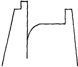
FIG. 44.- EL AGUA PRODUCIDA CONTRA LA EL POZO. EL PESO DE LA COLUMNA DE AGUA Y LODO EXCEDEN LA PRESIÓN DEL YACIMIENTO Y ENTONCES EL POZO NO FLUYE. 16
