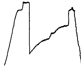
FIG. 26.—EFECTO DE RUSOSIDAD. EL MOVIMIENTO DE UNA EMBARCACIÓN FLOTANTE CAUSA ESTE TIPO DE GRÁFICA, O TAMBIÉN LA ACCIÓN DE BOMBLEAR. EL MOVIMIENTO DE LA EMBARCACIÓN ALCUNAS VECES PUEDE LIBERAR EL EMPACADOR. EL DST PUEDE SER NORMAL EN TODOS LOS ASPECTOS. 16
