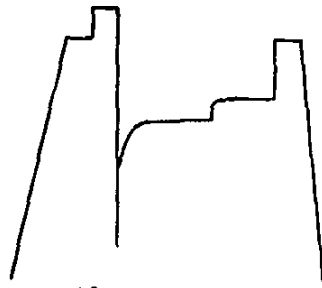
Fig. 48.- Flujo de una formación altamente permeable a través de un estrangulador. Las presiones y el gasto dependen de la transmisibilidad, presión de la formación, presiones diferenciales, diámetro del estrangulador, fluidos, etc. El incremento durante el flujo y el cierre es muy rápido y no se pueden obtener valores confiables del daño y la permeabilidad. 16
