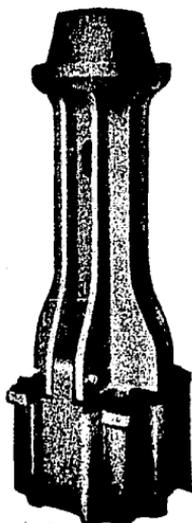
Yunque tipo Pedestal.- Se usa cuando los pilotes de concreto tienen varillas que sobresalen de la cabeza; la cachucha de que va provisto tiene todas las cualidades de la plana y además deja pasar las varillas por las muescas laterales sin perjudicarlas, cualquiera que sea su longitud, mediante ciertos arreglos; la cavidad superior que se ve, contiene un colchón de madera o fibra para recibir el golpe del borrego del martillo.
