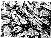
Fig. 29. Microestructura de la aleación Cu-Al (10% de Al) correspondiente a la muestra \beta 2, con 20% de deformación, formada por la fase \alpha primaria y eutectoide granular ( \beta + \alpha ). 50 X.
