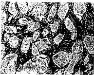
Fig. 28. Microestructura de la aleación Cu-Al (10% de Al) correspondiente a la muestra \beta 1, con 10% de deformación. Compuesta por la fase \alpha primaria con eutectoide granular ( \beta + \alpha ). 50 X.
