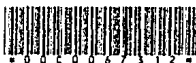
Fig. 3.- Etiqueta de identificación de un artículo, utilizando el código de barras de una franja.
