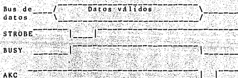
Fig. 5.2.4 Señales activadas durante el "Handshaking".
